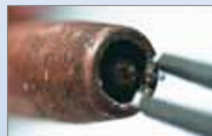
отрязване и издърпване на телта отвън
